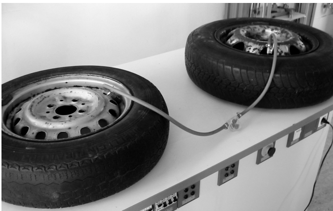
Abb. 1: Zwei Reifen sind über einen Schlauch mit einem Strömungsrädchen miteinander verbunden.
