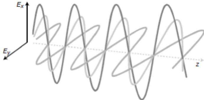
Fig.1 “Instantané” de l’extrémité du vecteur intensité du champ électrique dans une onde électromagnétique. Est-ce-que l’onde est non polarisée ?
