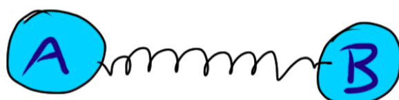
Fig. 1. Le ressort est soumis à une contrainte de tension. La quantité de mouvement de A augmente, celle de B diminue (la “quantité de mouvement négative” de B augmente).
