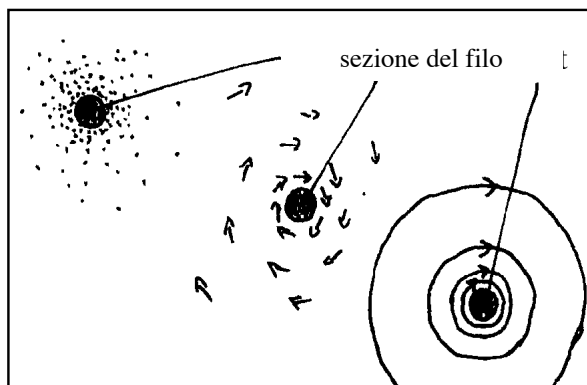
Fig. 18.32. Tre diverse rappresentazioni del campo magnetico nelle vicinanze di una corrente elettrica.
