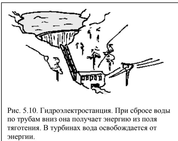
Рис. 5.10. Гидроэлектростанция. При сбросе воды по трубам вниз она получает энергию из поля тяготения. В турбинах вода освобождается от энергии.
