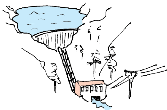
Fig. 5.16 Centrale idroelettrica. L'acqua scorre verso il basso nei tubi prendendo energia dal campo gravitazionale.
