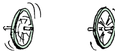
Fig. 3.12 La ruota che gira velocemente ha più quantità di moto angolare di quella che gira lentamente.
