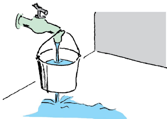
Fig. 2.25 Attraverso il foro esce la stessa quantità d'acqua che entra dal rubinetto. La quantità d'acqua nel secchio rimane costante. La quantità d'acqua nel secchio rimane costante.
