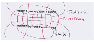
Das Feld drückt nach außen, d.h. es versucht, den Radius der Spulenwindungen zu vergrößern. In Spulenrichtung herrscht im Feld eine Zugspannung, das Feld hält sich an den Spulenenden fest, d.h. es drückt die Spule wie eine Schraubenfeder zusammen.
