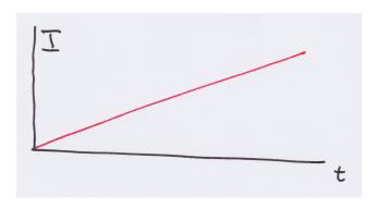
Die induzierte Spannung, und damit auch der induzierte elektrische Strom, ist proportional zu  $d\Phi/dt$ . Der magnetische Fluss  $\Phi$  ist proportional zur elektrischen Stromstärke im Primärkreis. Damit die Ableitung nach der Zeit t konstant ist, muss sich  $\Phi$  linear mit t ändern.
