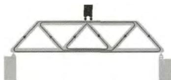
图5  $x$ 方向的动量流图
