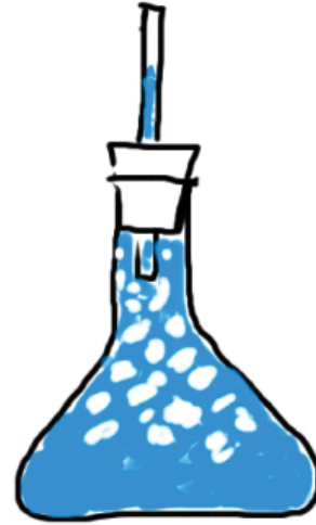
Abb. 5.4 Man führt der Eis-Wasser-Mischung den zu messenden Entropiebetrag zu. Die Menge des dabei schmelzenden Eises ist ein Maß für die zugeführte Entropie.
