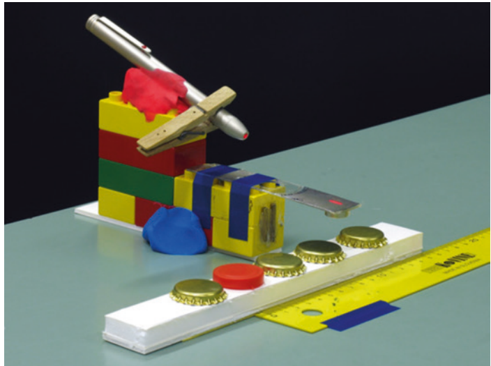
■ Abb. 11.8 Modell eines Rasterkraftmikroskops für den Unterricht (Planinsic und Kovac 2008)
