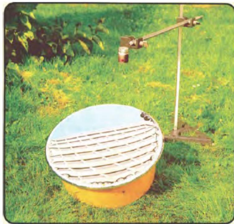
用这个凹面镜你可以聚集太阳光，使纸张立即燃烧起来。如果你将光聚集在一个盛水的小黑色罐头，几分钟后水就会沸腾（见上图）。
