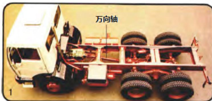
如果你观察一下卡车底部，你能看到万向轴（图1）。能量通过它从发动机传递到后轮。
