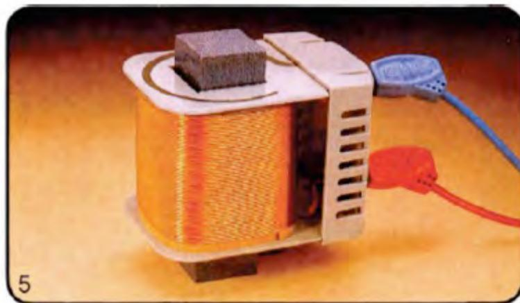
只要有电流通过电磁铁，它就会吸引铁质微粒。电流越大，这吸引力就越大。电流一消失，电磁铁的磁性就消失。
