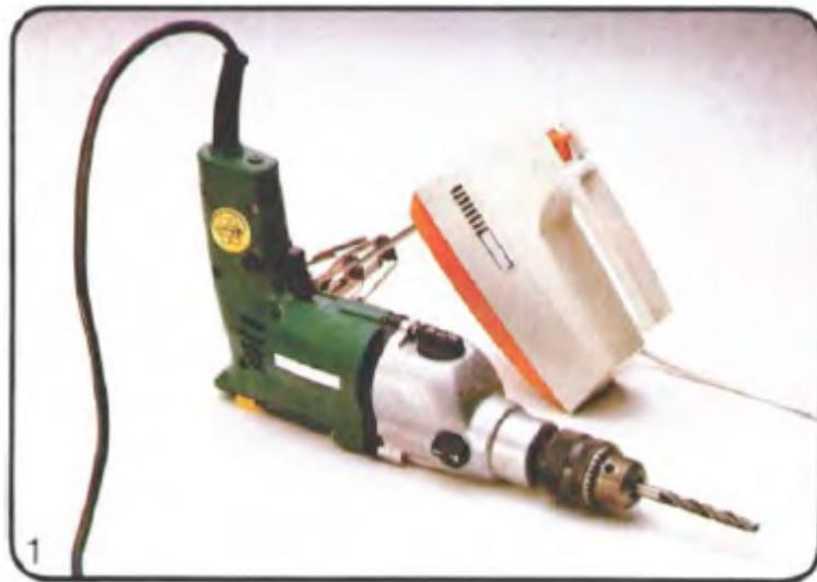
在这两个装置外壳的一个边上都开有窗口。在运行时，空气从其中一个窗口流出，从另一个窗口流入。也许你能想象出这空气是用来干什么的。电动机必须冷却。如果你关闭这个空气出口，电动机就会发热，甚至烧掉。流出的空气比流入的空气要热。这空气携带着能量从装置中流出。
