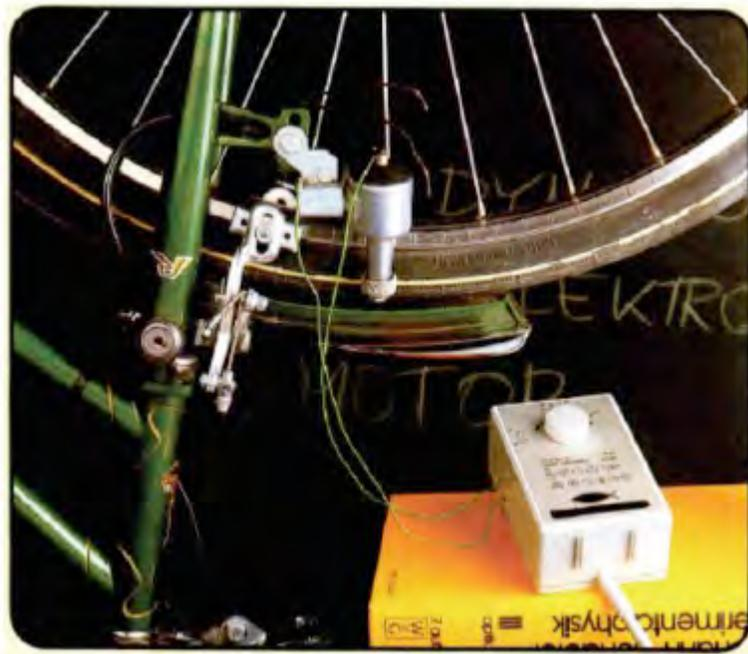
把自行车翻过来，轮胎朝上。将发电机扣在自行车轮子上（如果你转动自行车轮子，发电机转轴必须会跟着转动。）将发电机的两个接头（螺钉和外壳）与变压器的两个插座相连。发电机驱动自行车轮子转动起来了。你启动了发电机（实为电动机）。
