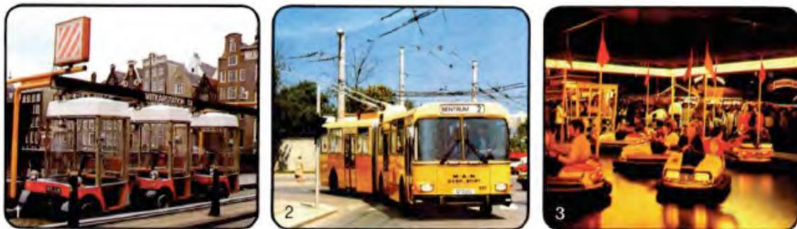
汽车行驶需要能量。因此多数汽车有能量储存器，即油箱。也有些交通工具的能量储存在电池中（图1）；但有些汽车没有能量储存器（图2和3），这些汽车没有象带有能量储存器的汽车那样有较大的行驶自由度。具有能量储存器的汽车能行驶到电源线（电缆）或燃油管道没有通到的地方。因此，当你使用储油箱时，在没有电源线的地方你也有能量。
