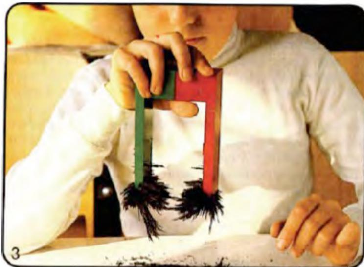
对于条形磁体，其磁极在其两端。对于图1所示的圆盘型磁体，其两个大的面就是磁极。如果你将条型磁体用细线悬挂起来，使其能转动，那么它最后会指出南/北方向。指向北极的那个磁极叫作北极，指向南极的那个磁极叫作南极。指南针就是能自由转动的条形磁体。
