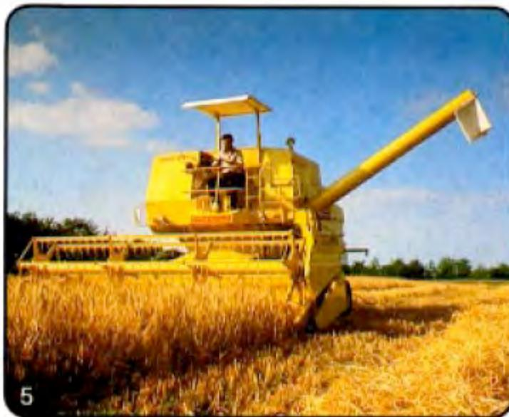
联合收割机在农田中行驶，用收割器将谷物割下来。谷物自动地被传输到脱粒机中，谷粒在这里从谷穗中脱落下来。没有谷粒的草秆从机器后面被吐出来。谷粒被收集到机器顶部的大容器中。容器中的谷粒不时地被卸出。联合收割机也用传动
