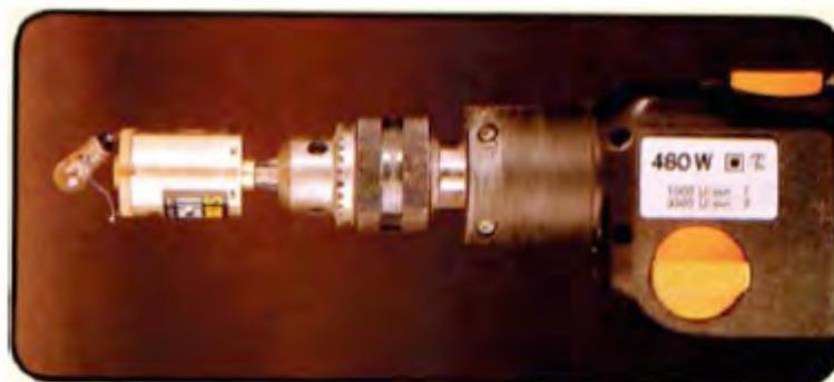
先将电灯与发电机相连。用电钻驱动发电机，换句话说，发电机将用携带者角动量从电钻吸取能量。为此，发电机的转轴必须夹到电钻的钻头夹盘中。现在我们
