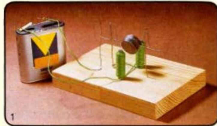
*Die Motorwelle:* Biege eine Büroklammer so auf, daß ein Stück gerader Draht entsteht. Befestige an diesem Draht mit Klebeband oder Klebstoff die Dauermagnete. Die beiden Nordpole müssen in dieselbe Richtung weisen, und die beiden Südpole in die entgegengesetzte Richtung. Bild 3 oben. Die Aufhängung für die Motorwelle bilden zwei aufgebogene Büroklammern, die auf dem Holzbrettchen befestigt werden. Verbiege das eine Ende
