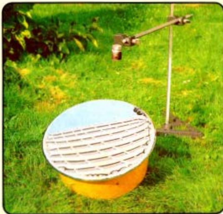
Mit diesem Spiegel kannst du Sonnenlicht so stark konzentrieren, daß Zeitungspapier sofort Feuer fängt. Lenkst du den konzentrierten Lichtstrahl auf eine kleine rußgeschwärzte Konservenbüchse, in der sich Wasser befindet, so fängt das Wasser nach einigen Minuten an zu sieden (unteres Bild).
