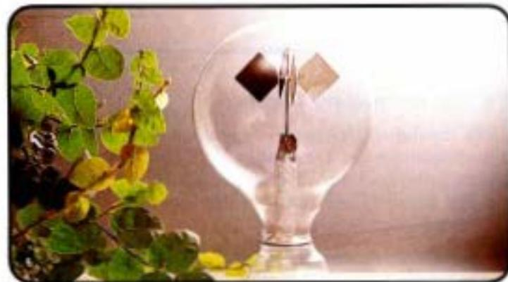
betreiben, daß man die Solarzellen mit einer starken Glühlampe beleuchtet, und auch die Lichtmühle läuft im Lampenlicht. Nicht nur Sonnenlicht trägt Energie, sondern jedes andere Licht auch.
