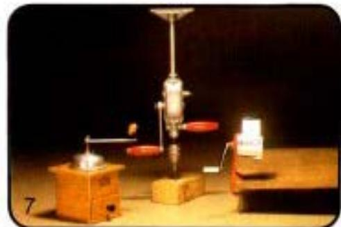
Empfänger für Energie mit dem Träger Drehimpuls: Bohrmaschine, Kaffee-, Mandelmühle.
