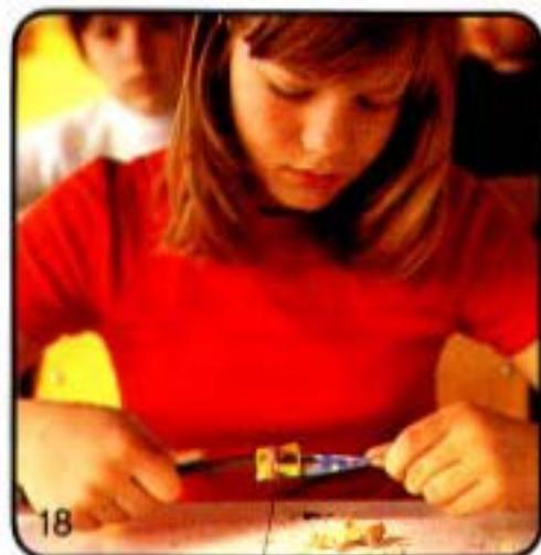
Schneide ein rechteckiges Stück Plastik aus, und bau es in einen Drehimpulsstromkreis ein, Bild 16. Der Plastikstreifen wird vom Drehimpulsstrom, der durch ihn hindurchfließt, verdrillt. Der Bleistift selbst spürt natürlich dasselbe wie der Plastikstreifen, nur sieht man es ihm nicht an, da er härter ist.
