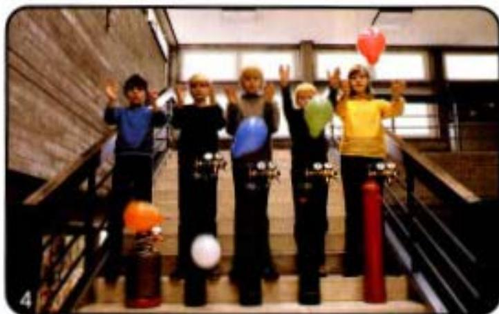
Wasserstoff ist leichter als Luft. Kohlenstoffdioxid und Propan sind schwerer als Stickstoff.
