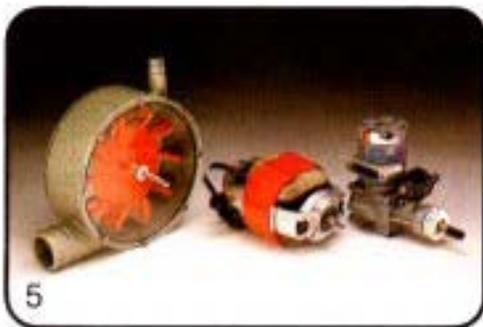
Quellen für Energie mit dem Träger Drehimpuls: Wasserturbine, Elektro-, Benzinmotor.
