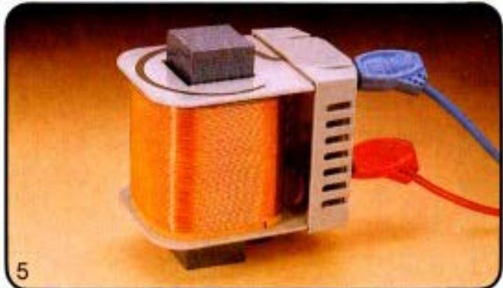
Ein Elektromagnet zieht Eisenteile an, solange er von einem elektrischen Strom durchflossen wird. Je größer die Stromstärke ist, desto stärker zieht er. Sobald der Strom aufhört zu fließen, zieht der Magnet nichts mehr an.
