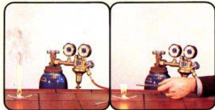
eine rußende Flamme. Das Petroleum verbrennt unvollständig. In die Flamme wird nun durch ein Röhrchen reiner Sauerstoff geleitet. Die Rußentwicklung hört auf.
