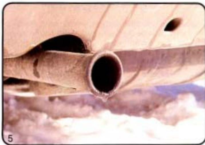
Im Auspuffrohr sammelt sich eine Flüssigkeit.
