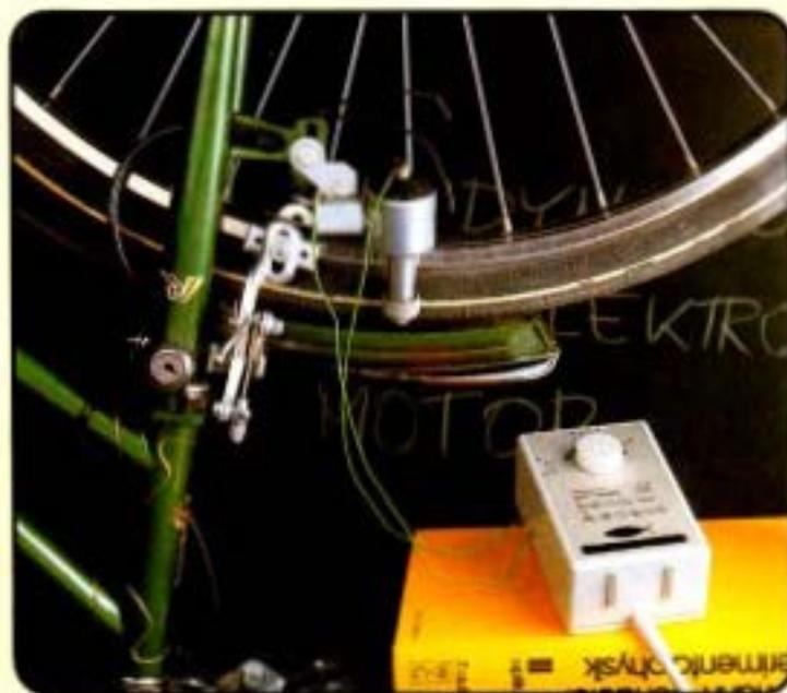
dynamo selbst ausprobieren, falls du einen Trafo hast, der am Ausgang etwa 8V hat. Einen Trafo brauchst du deshalb, weil dazu Wechselstrom erforderlich ist. Mit Batterien geht das Experiment nicht.
