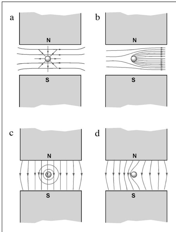
Abb. 3. (a) Die ruhende, positiv geladene Kugel erzeugt ein radiales, der in die Bildebene hinein bewegte Magnet ein homogenes elektrisches Feld. (b) Das resultierende elektrische Feld zieht die Kugel nach rechts. (c) Der ruhende Magnet erzeugt ein homogenes, die aus der Bildebene heraus bewegte Kugel ein zylindersymmetrisches magnetisches Feld. (d) Das resultierende magnetische Feld drückt die Kugel nach rechts.
