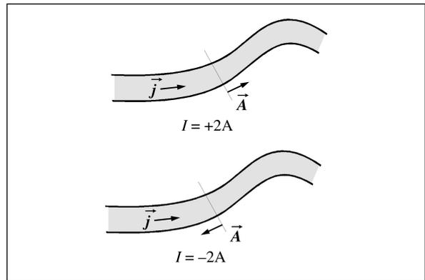
Abb. 2. Der Wert der Stromstärke desselben Stroms ist positiv oder negativ, je nach Orientierung der Bezugsfläche.
