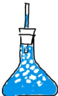
图 4-35-1. 所测的熵被传递到冰水混合物中。冰的熔解量是所提供的熵的量度。
