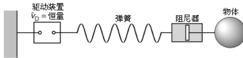
图 7-2-2 串联振子具有恒定的速度振幅。
