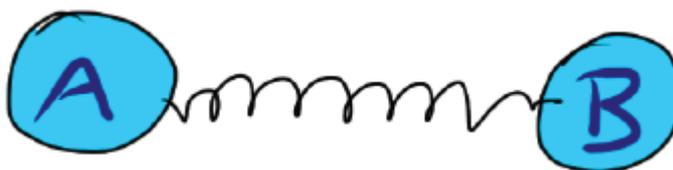
图 1-2-1 弹簧处于拉伸状态。A 的动量在增加，B 的动量在减少（B 的“负动量”在增加）。
