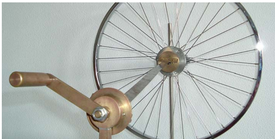
Abb. 5: Der Drehimpulsstrom in einer Welle wird durch die Verdrillung sichtbar gemacht.
