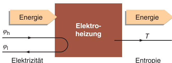
Abb. 2: Energieumladerbild einer Elektroheizung
