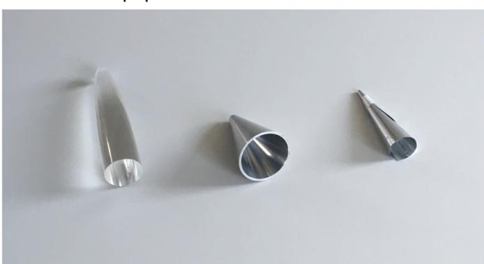
Abb. 3. Links: Bestmöglicher Konzentrator aus Plexiglas; Mitte: Kegelförmiger Konzentrator aus Aluminium; rechts: Primitive Version aus Geschenkpapier
