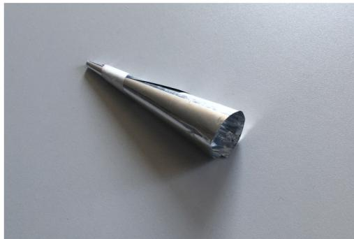
Abb. 2. Einfacher Lichtkonzentrator aus Geschenkpapier
