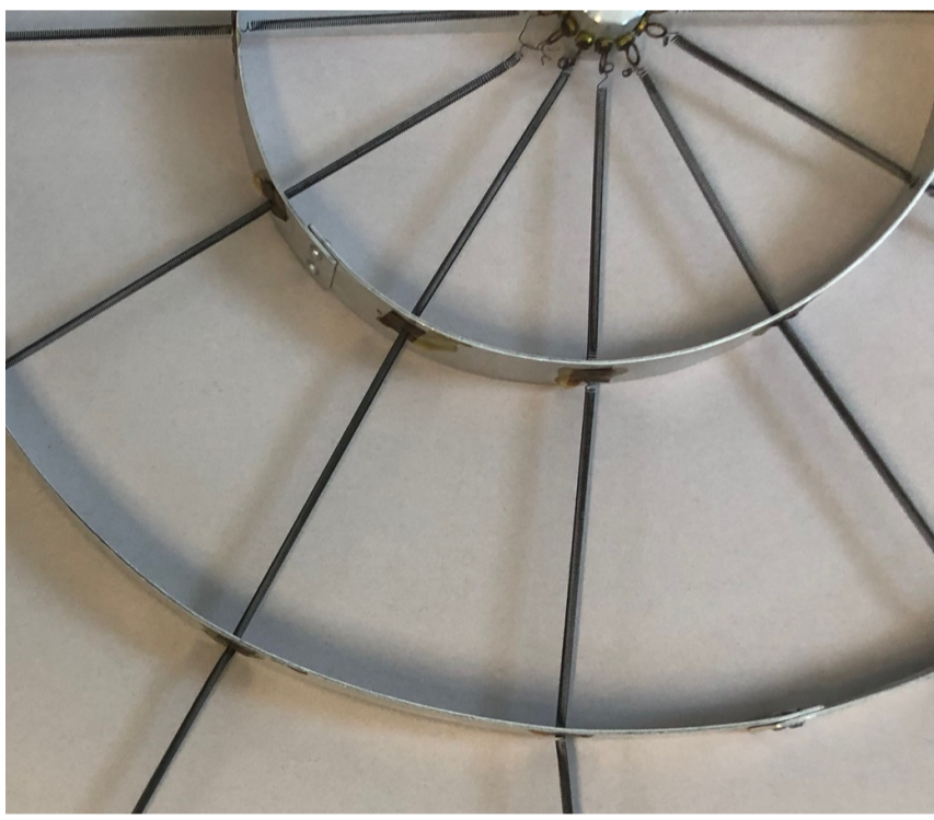
Abb.1. In den radialen Federn herrscht Zugspannung, sie nimmt von innen nach außen schrittweise ab. Die Ringe stehen unter Druckspannung.
