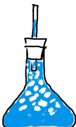
Abb. 1. Man führt der Eis-Wasser-Mischung den zu messenden Entropiebetrag zu. Die Menge des dabei schmelzenden Eises ist ein Maß für die zugeführte Entropie.
