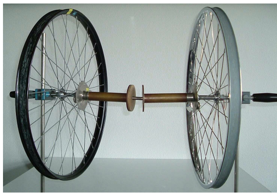
Abb. 1. Links: Rutschkupplung aus Flaschenkorken und Gartenschlauch (oben) oder mit zwei Scheiben und einem Zentrierstift; rechts: Elastische Kopplung mit Spiralfeder
