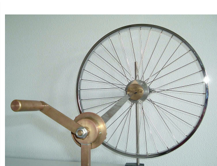
Abb. 2. Das Schwungrad wird durch drehen der Kurbel mit Drehimpuls geladen. Der Drehimpuls fließt durch das Stahlband von der Kurbel zum Schwungrad. Man sieht dem Drehimpulsleiter an, ob und wie viel Drehimpuls (pro Sekunde) fließt, d.h. wie stark der Drehimpulsstrom ist.
