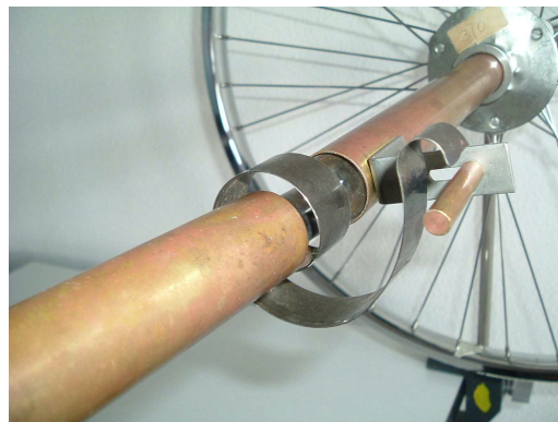
Abb. 1. Links: Rutschkupplung aus Flaschenkorken und Gartenschlauch (oben) oder mit zwei Scheiben und einem Zentrierstift; rechts: Elastische Kopplung mit Spiralfeder
